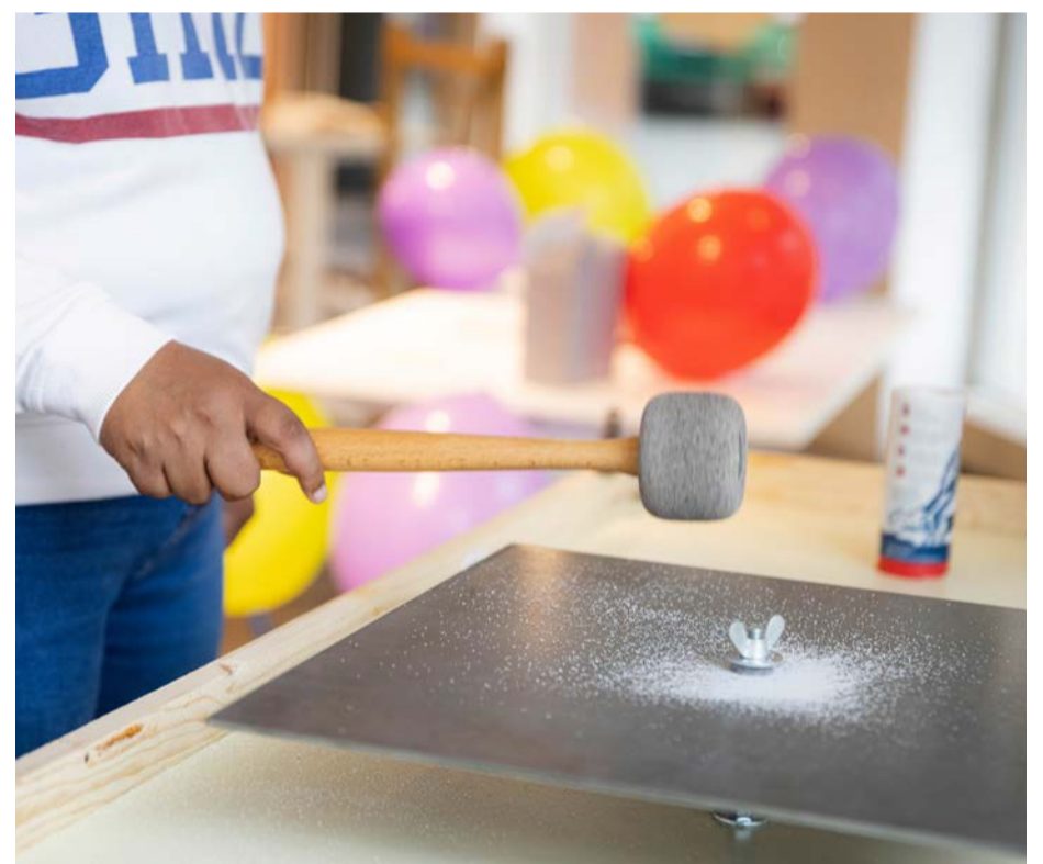
Die Salzkörner hüpfen mit den Schallwellen, so wird ein Geräusch plötzlich sichtbar.
